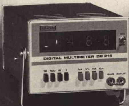
Adatto per la misura di tensioni continue ed alternate con indicatore automatico di polarità, correnti continue e resistenze.
