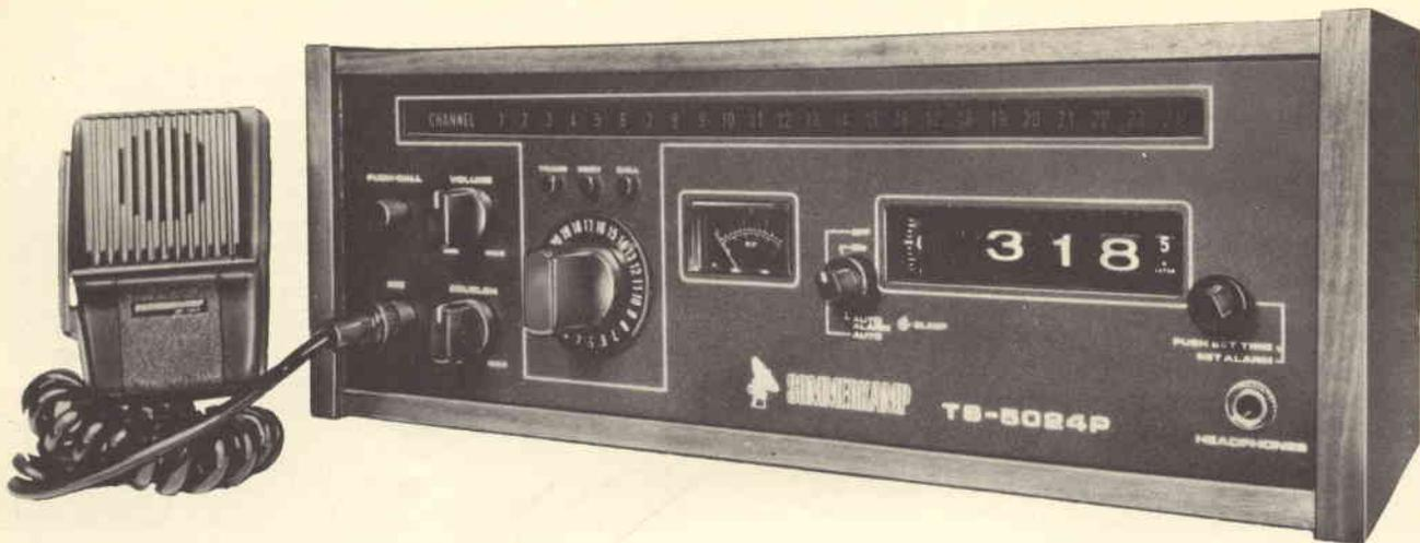
Ecco ora il TS/5024P, stazione fissa alimentata soltanto dalla rete luce 220 Vc.a. Il motivo è chiaro: lo stadio finale di potenza a transistori è alimentato a 28 Vc.c. Tutti gli stadi di cui è composto il TS-5024P sono a transistori e stabilizzati mediante diodi Zener. Impiega 28 transistori, 19 diodi e 1 SCR. Ha una sensibilità in antenna di 0,35  $\mu$ V per una potenza d'uscita sull'altoparlante di 500 mW. La potenza di uscita audio massima è di 5 W.
